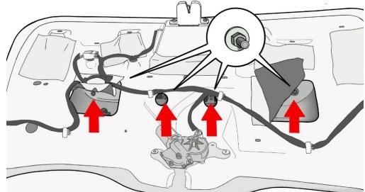
7. ПРОГРЕЙТЕ НАРУЖНУЮ НАКЛАДКУ СТРОИТЕЛЬНЫМ ФЕНОМ (ТЕМПЕРАТУРОЙ ОКОЛО 100 С) И СНИМИТЕ ЕЕ
