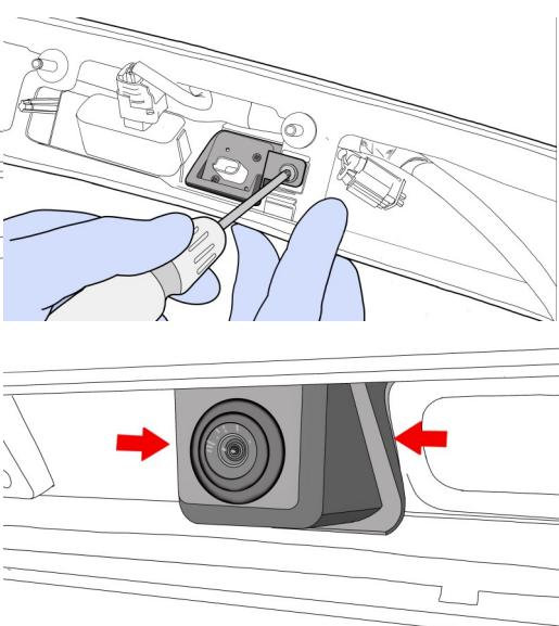
**10. ДЛЯ АВТОМОБИЛЕЙ ДО РЕСТАЙЛИНГА 2020г ОТВЕРНІТЕ 2 ВИНТА КРЕПЛЕНИЯ КАМЕРЫ К КРОНШТЕЙНУ И УСТАНОВІТЕ КАМЕРУ НА НОВЫЙ КРОНШТЕЙН QR КОДОМ ВВЕРХ, КАК ПОКАЗАНО НА ФОТО**
