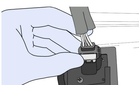
9. ОТВЕРТКОЙ TORX T20 ОТВЕРНТЕ ВИНТ КРЕПЛЕНИЯ КАМЕРЫ ЗАДНЕГО ВИДА ИЛИ ОСВОБОДИТЕ 2 ФИКСАТОРА (ДЛЯ АВТОМОБИЛЕЙ ПОСЛЕ РЕСТАЙЛИНГА 2020 ГОДА) И СНИМИТЕ КУМЕРУ
