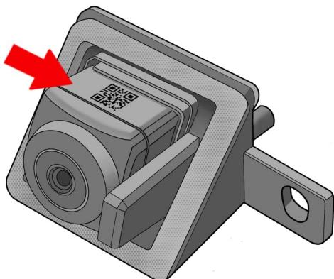
**11. ДЛЯ АВТОМОБІЛЕЙ ПОСЛЕ РЕСТАЙЛІНГА 2020г ОТВЕРНІТЕ 2 ВИНТА КРЕПЛЕНИЯ КАМЕРЫ К КРОНШТЕЙНУ, ОСВОБОДІТЕ ФІКСАТОР И ИЗВЛЕКІТЕ КАМЕРУ ИЗ КРЕПЛЕНИЯ. УСТАНОВІТЕ КАМЕРУ НА НОВИЙ КРОНШТЕЙН НАКЛЕЙКОЙ ВВЕРХ, КАК ПОКАЗАНО НА ФОТО**
