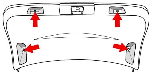
2. СНИМите ПЛАСТИКОВУЮ ОБИВКУ КРЫШКИ БАГАЖНИКА
