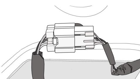
5. СНИМите РАЗЪЕМ С ЗАМКА КРЫШКИ БАГАЖНИКА
